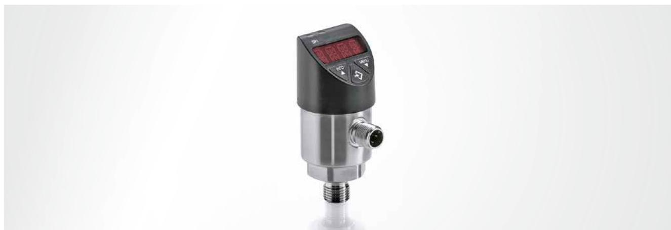
El monitor de presión electrónico sirve para controlar la presión de los sistemas de nitrógeno. Al alcanzar los valores límite configurables a discreción, envía las señales correspondientes al control de la máquina, donde se pueden utilizar para generar mensajes de advertencia o para parar la máquina.
