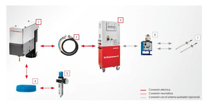
La unidad S-Former E es un sistema electrónico para formación de rosca integrada en el proceso. El servomotor montado en el cabezal de formado impulsa el formador de rosca. El movimiento del formador de rosca hacia la pieza es neumático y el formador se va introduciendo en el material siguiendo el paso de rosca. El control PLC regula y vigila el servoaccionamiento y, por tanto, la formación de rosca.
