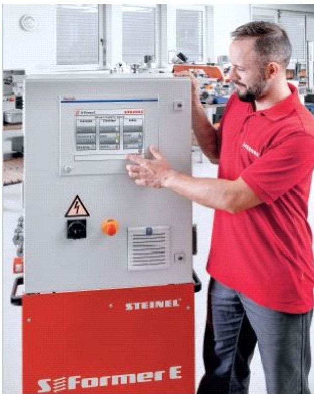
Operación intuitiva: El control del S-Former E con pantalla táctil de 12"
