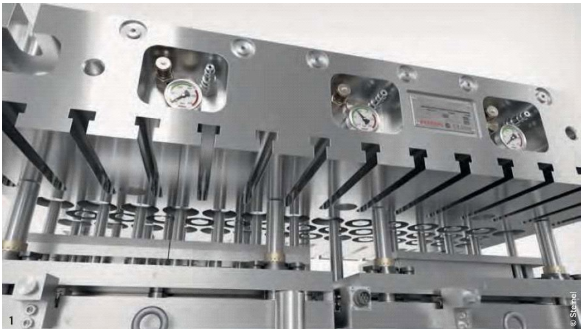
Placa manifold como parte superior del troquel en troquelería progresiva
